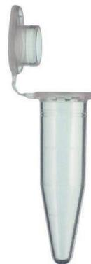
Microtubos de centrifugação tipo Eppendorf. Cada vez mais utilizados, pois as reações estão menores e não precisam de recipientes grandes. Produzido em polipropileno com tampa do tipo "Snap Cap" para melhor vedação.
