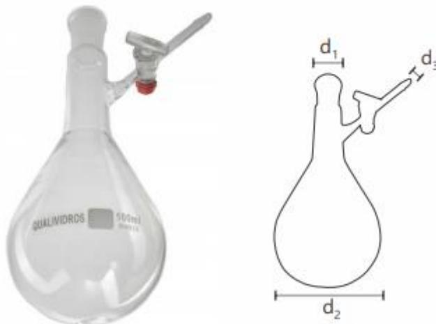
Utilizado em pesquisa química ou laboratorial de materiais para realizar experimentos sob vácuo e atmosfera inerte (como nitrogênio ou argônio).
