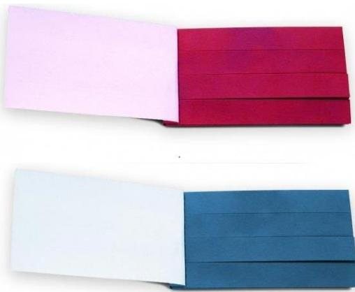
O papel de tornassol é um papel indicador embebido com uma tintura orgânica que muda de cor na presença de ácidos e de bases. É utilizado quando se quer determinar, simplesmente, se a solução é ácida ou básica, pois o Tornassol não providencia nenhuma informação adicional.
