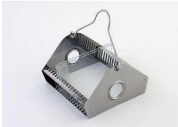
Berço para coloração de lâminas, posicionadas horizontalmente, para análise histológica, patológica ou microbiológica. Fabricado em chapa de aço inox.
