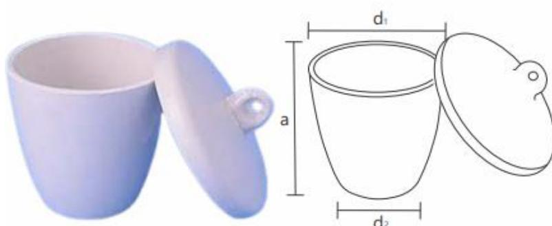
Cadinhos forma BAIXA são compostos formando uma porcelana refratária com os elementos - zircônio e óxido de alumínio. Utilizados para calcinação e fusão de materiais sólidos ou pastosos, normalmente em muflas, nas temperaturas entre 1.200 a 1.500°C.
