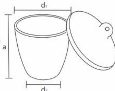
Cadinhos forma MÉDIA são compostos formando uma porcelana refratária com os elementos - zircônio e óxido de alumínio. Utilizados para calcinação e fusão de materiais sólidos ou pastosos, normalmente em muflas, nas temperaturas entre 1.200 a 1.500°C.
