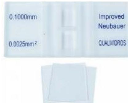
Utilizado em laboratório para a contagem de células ou outras partículas em suspensão em conjunto com microscópio. São instrumentos de precisão, feitas de vidro ótico especial. Usada para determinar a quantidade de células e outras estruturas em amostras, como sangue e urina.
