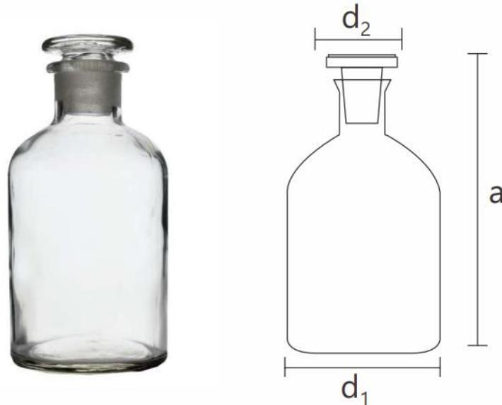
Utilizado para armazenamento de diversos reagentes e para mistura de meios de cultura ou amostras líquidas. Acompanha rolha de vidro esmerilhada intercambiável. Não Autoclavável.
