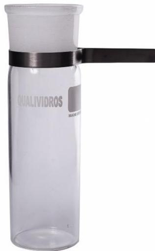
Utilizado em processos industriais de destilação. Ele é parte de uma unidade de destilação, que separa líquidos de diferentes pontos de ebulação, como na produção de petróleo ou na fabricação de produtos químicos. Junta côncica, fundo chato para adaptar em sistema de gordura macro. Compatível com o equipamento da marca TECNAL/TE-044/50
