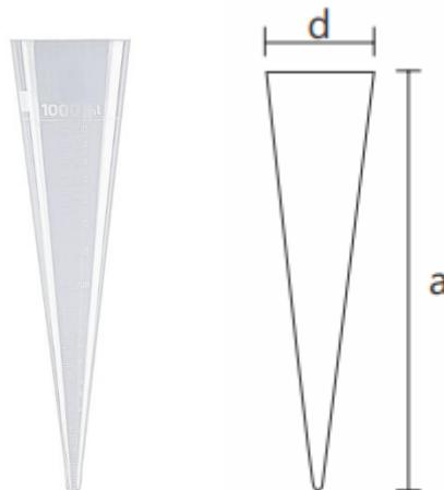
Utilizado para determinação dos sólidos sedimentáveis. Com graduação (Graduação com divisão de 1ml até a capacidade de 40ml; divisão de 2ml até a capacidade de 100ml e divisão de 50ml até a capacidade de 1000ml). Fabricado de acordo com a Norma DIN 12672, gravação em tinta cerâmica de alta durabilidade na cobrança, tarja para facilitar a marcação, possui alta resistência a ataques químicos, acabamento superior. A calibração é baseada no volume ("In") a20°C.
