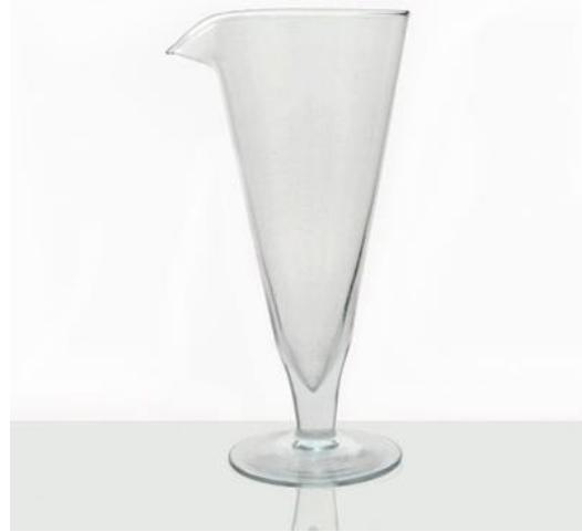
Utilizado para reter e conservar fluidos e compostos e facilitar a formação de precipitados em variadas reações químicas. Apresenta uma base em forma de cone ideal para sedimentações em processos de análises clínicas.
