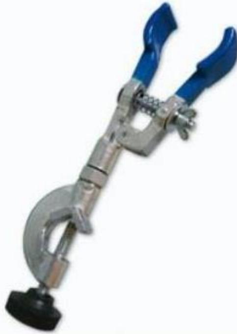
Fabricada em alumínio fundido. Ajuste de 360º sobre o eixo central (para frente ou para trás). Garras em pá revestidas em PVC e Regulagem de abertura por molas de pressão ou porcas; Parafuso de fixação tipo borboleta, em alumínio e poliestireno colorido injetado; Acabamento jateado. Fabricada em alumínio fundido. Garras revestidas em PVC.
