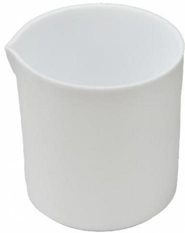
Becker em PTFE opaco, sem graduação, resistente a temperatura de utilização de -270°C a +260°C. Com comprovada resistência química à maioria dos reagentes e baixíssimo coeficiente de atrito (antiaderente), são inquebráveis, fáceis de limpar, autoclaváveis e podem ser esterilizados por qualquer método.
