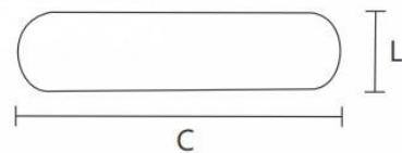
Barra magnética revestida em PTFE resistente a produtos químicos, de grande durabilidade, sem soldas, mono-molde, impedindo a penetração de produtos no seu interior (impermeável), não descartável, com imã em alnico V de alta intensidade. Resistente a temperaturas de -270 à +260 °C. Sem anel.
