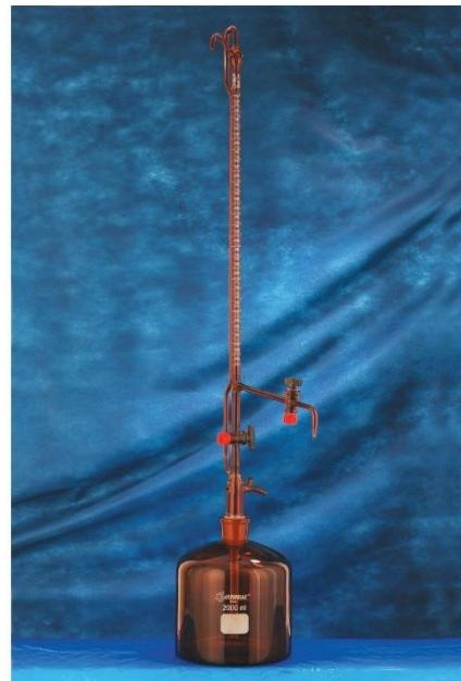
Vidraria Classe A com intervalo de graduação de 1/20ml, acompanha frasco para solução com capacidade de 1 ou 2 litros, torneira de teflon espessura maior que 2mm. Tolerância expressa na vidraria  $\pm 0,03\text{ml}$  divisão 0,05ml; Comp. aprox. 470mm; Temperatura de referência 20°C em vidro borossilicato. Opcional: Solicitar Vidraria c/Nº de serie gravado, certificado de calibração e pera de succão (mangueira inclusa).
