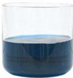
Utilizada no processo de cristalização em diversas aplicações, as cubas de vidro apresentam uma ampla área de contato e são perfeitas para agilizar a evaporação dos solventes, inclusive de forma mais veloz.
