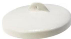
Utilizados para calcinação e fusão de materiais sólidos ou pastosos, normalmente em muflas, nas temperaturas entre 1.200 a 1.500°C.
