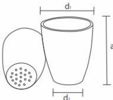
Utilizado para filtração e obedece as mesmas normas dos cadiinhos de fusão. Feito com porosidade de 7 e 8 microns, utilizado para filtração a vácuo e destinado a analise de alcatrão ou outros derivados. Material: Porcelana refratária com os elementos - zircônio e óxido de alumínio.
