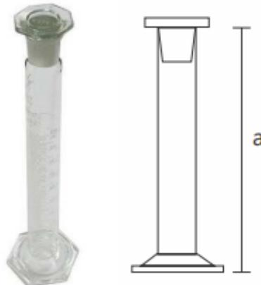
Utilizado com bastante frequência em laboratórios, escolas, universidades, indústria farmacêutica, entre outras áreas, a proveta de vidro tem como principal função medir volumes de líquidos com baixa precisão. Calibrada a 20°C, graduada permanente. Autoclavável a 121°C. Possui rolha de vidro.
