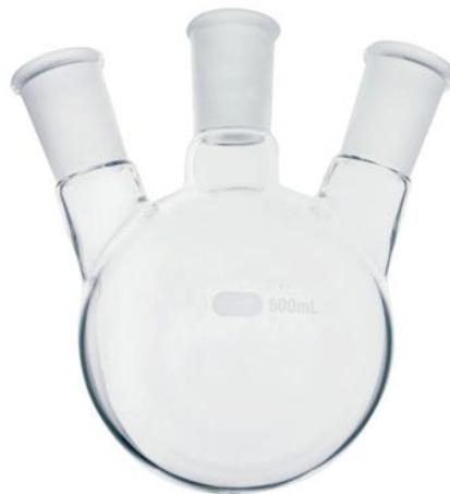
Utilizado nas destilações químicas, apropriado aos aquecimentos sob refluxo e evaporação a vácuo.
