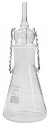
Utilizado em laboratórios para ensaio da densidade de agregados e em reações químicas em geral.
