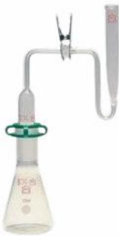
Utilizado para determinação de arsênio pelo método fotométrico de dietilditiocarbamato de prata. Possui juntas de vidro esmerilhadas.
