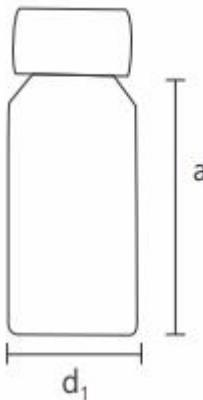
Utilizado para armazenamento de líquidos e/ou amostras à luz, como produtos químicos, reagentes ou amostras biológicas. A cor âmbar do vidro ajuda a proteger o conteúdo da degradação causada pela luz ultravioleta.
