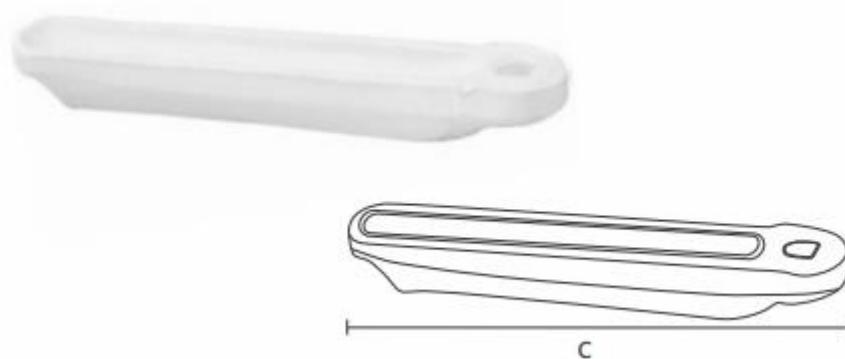
Utilizada na análise de carbono e enxofre, em fornos de tubo com injeção de oxigênio, normalmente a uma temperatura aproximada de 1250°C.
