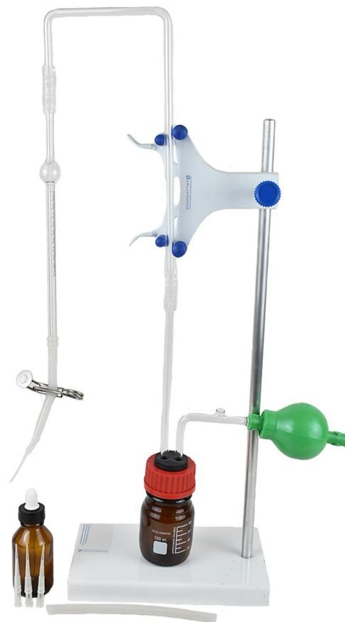
Equipamento destinado a determinar o grau de acidez do LHO. Utilizado para determinar o grau de acidez do leite, indicado pela presença de ácido láctico devido à degradação da lactose durante a proliferação microbiana.
