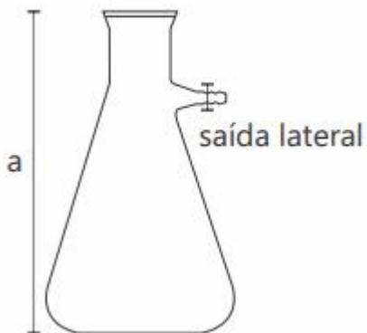
Utilizado na filtração a vácuo, ou sob pressão, e é o recipiente de recolha do fluído que se pretende separar da fase sólida por filtração. Com saída superior.
