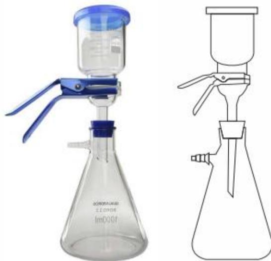
Utilizado para filtração de água, preparação de amostras para microbiologia, quantificação de partículas e em filtração de solventes para HPLC. Acompanha Tampa para o copo; Receptor: Frasco kitazato; Pinça: Em metal na cor azul; Junção com membrana filtrante de vidro 47 mm; Calibração: Calibrado a 20°C.
