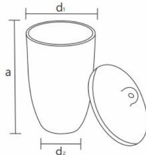
Utilizados para calcinação e fusão de materiais sólidos ou pastosos, normalmente em muflas, nas temperaturas entre 1.200 a 1.500°C.
