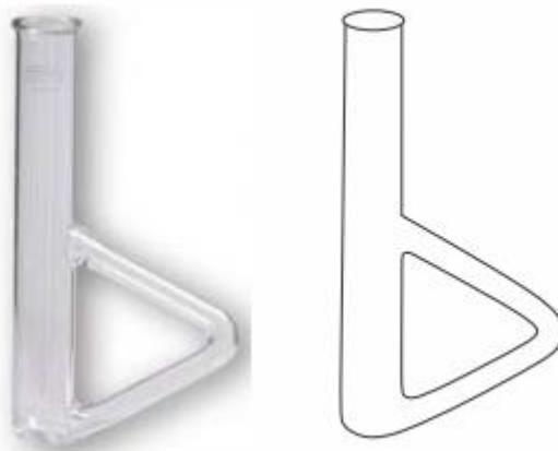
Utilizado principalmente, para determinação de pontos de fusão de substâncias. Munido de um braço lateral (bypass) onde se realiza o aquecimento do líquido contido no tubo. O Tubo de Thiele, assim denominado devido ao químico alemão Johannes Thiele;
