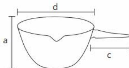
Utilizada no Bico de Bunsen ou chama direta de fogão a gás para a fervura, cozimento ou até a simples evaporação. Suportam temperaturas, especificamente nos estados de ebulição, com resistência a choque térmico entre 400/500°C para 20°C. Não deverá ser usada sem a presença de líquidos em seu interior.
