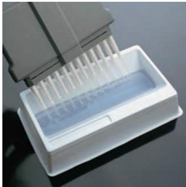
Utilizado para pipetagem em laboratórios, dupla face, praticidade de um poço único com a precisão de canaletas individuais para pipetas de 8 e 12 canais.
