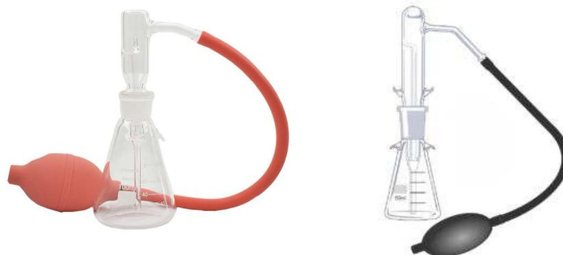
Utilizado para analisar, identificar ou separar os componentes de uma mistura em laboratórios, modelo tpara cromatografia em camada delgada.
