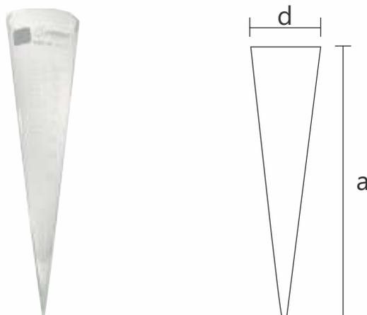
Utilizado para determinação dos sólidos sedimentáveis. Com graduação (Graduação com divisão de 1ml até a capacidade de 40ml; divisão de 2ml até a capacidade de 100ml e divisão de 50ml até a capacidade de 1000ml). Fabricado de acordo com a Norma DIN 12672, gravação em tinta cerâmica de alta durabilidade na cor branca, tarja para facilitar marcação, possui alta resistência a ataques químicos, acabamento superior. A calibração é baseada no volume ("In") a 20°C.
