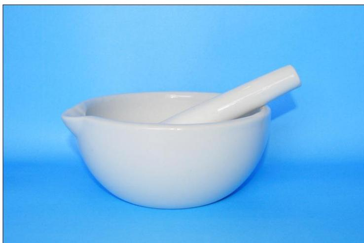
O gral é fabricado em porcelana de alta resistência. A queima processada a 1.300°C com dureza entre 6 a 8 mols (57.5 na escala Rockwell 45). Esmaltação ou vitrificação por imersão com aderência de + ou - 0.2 mm. Utilizado em moagem e trituração de produtos químicos e outros. Acompanha pistilo, com cabo totalmente em porcelana.
