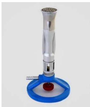
Fonte de aquecimento usada em laboratório com regulagem para entrada de ar, manípulo para regulagem de gás com registro. Grelha e base.
