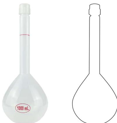
Utilizado para medir volumes de líquidos ou soluções de forma extremamente precisa e exata. A grande vantagem do balão de plástico é justamente a durabilidade, já que cada modelo é produzido com polipropileno reforçado para aumentar a resistência. Também é um material que torna o produto fácil de lavar. Acompanha tampa de poli.
