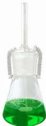
Utilizado para ensaio da densidade de agregados e em reações químicas em geral.
