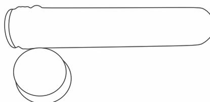
Utilizado para acondicionamento em laboratório, teste de esterilidade; Com tampa de rosca.
