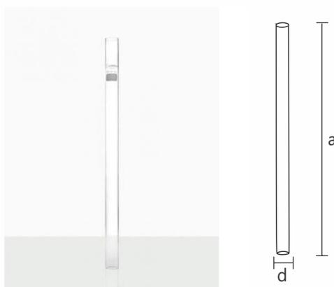
Utilizado em laboratórios para avaliação da reação de determinadas substâncias ao reagente Nessler, um material que identifica o nitrogênio do tipo amoniacal nas amostras. Este produto possui a qualidade Classe A e gravação em tinta cerâmica na cor branca de alta durabilidade
