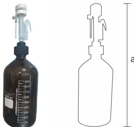
Utilizado para transferir líquidos de um recipiente para outro de forma precisa. Compostos por uma seringa de vidro e um frasco na cor âmbar com graduação permanente na cor branca para melhor visualização.
