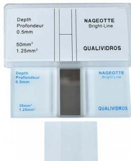
Utiizada para contagem manual de baixas concentrações de leucócitos, abaixo da capacidade dos hemocitômetros padrão. A leitura da amostra é feita através de uma rede de contagem localizada na base central da câmara. A profundidade da câmara é de 0,5 mm. Na imagem ao microscópio, é vista uma base quadrada de 100 mm<sup>2</sup> dividida em 40 retângulos, cada um com área de 0,25 mm x 10 mm = 2,5 mm<sup>2</sup> e volume de 2,5µl (40 x 2,5µl = 100µl).
