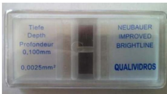
Utilizado em laboratório para a contagem de células ou outras partículas em suspensão em conjunto com microscópio. São instrumentos de precisão, feitas de vidro ótico especial. Utilizadas para análise de células do sangue em altas ou baixas concentrações (leucócitos, eritrócitos e trombócitos, células do liquor ou para a contagem em altas ou baixas concentrações de bactérias e esporos de fungos. A base da câmara é revestida com ródio e a rede de contagem (quadrantes) é gravada no revestimento.
