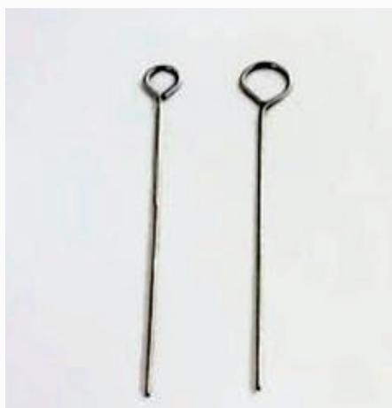
Usada em laboratório de microbiologia acoplada ao Cabo de Kolle, a alça com virola é utilizada para transferir inóculos sólidos ou em suspensão e a agulha é utilizada para semear meio sólido em profundidade.
