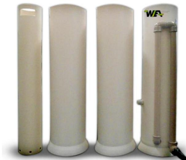
Lavador automático de pipetas, equipamento indispensável em laboratórios, pois proporciona a lavagem de um grande número de pipetas de uma só vez.
